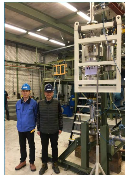
水下多相流量计第三方环线测试 (荷兰DNV环线)
